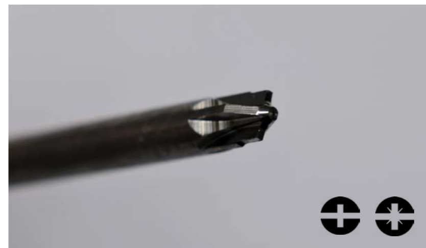
4 PlusMinus-Schraubendreher- klinge nach der Bearbeitung
