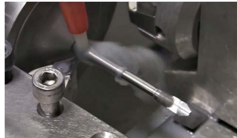
3 Langdrehen und Auswurf des fertigen Werkstückes
