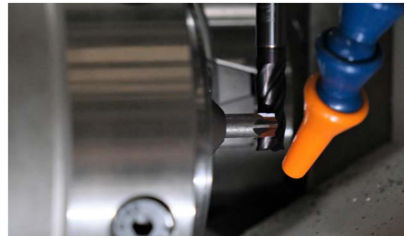
3 Fräsen der überstehenden Kanten
