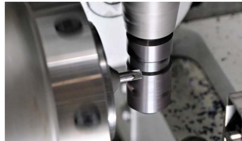
2 Wälzschlagen von PlusMinus- Schraubendreherklingen
