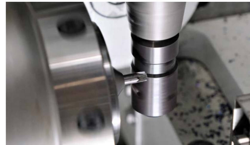
2 Génération de profils de lames de tournevis PlusMinus
