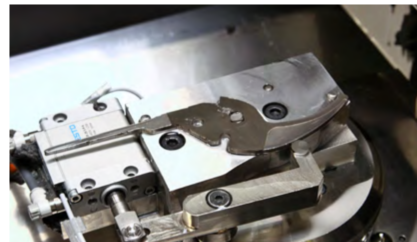
4 Planschliff an Gartenscheren mit Seiten-Flächenschleif- maschine DG2
