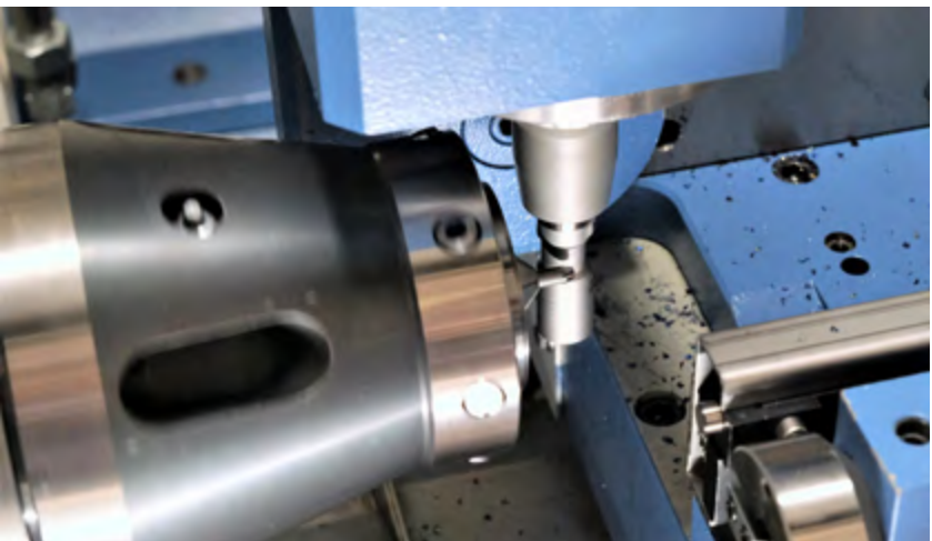
3 Wälzschlagen der Kugelpf- Schraubendreherklinge
