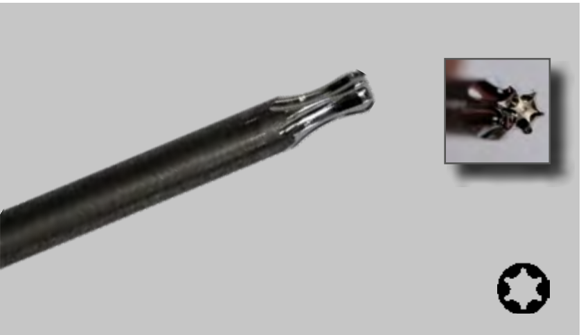
4 Torx-Kugelpf-Schraub- dreherklinge nach der Be- arbeitung
