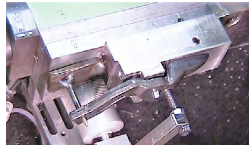
3 Flächenschliff an Blech- scheren mit Seiten-Flächen- schleifmaschine BG1
