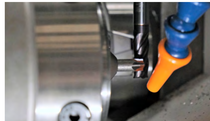
3 Fräsen der überstehenden Kanten
