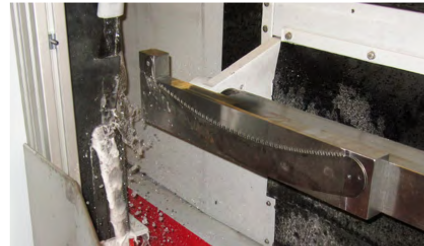
1 Konischer Hinterschliff an Sägeblättern mit Seiten-Flä- chenschleifmaschine BG
