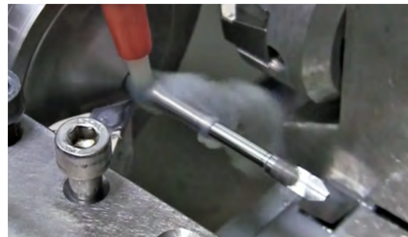
3 Langdrehen und Auswurf des fertigen Werkstückes
