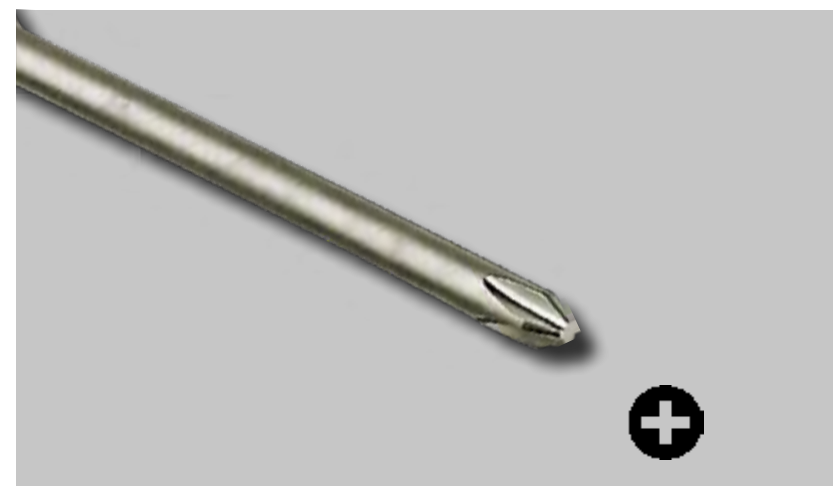
4 Kreuzschlitz -Schrauben- dreherklinge nach der Be- arbeitung
