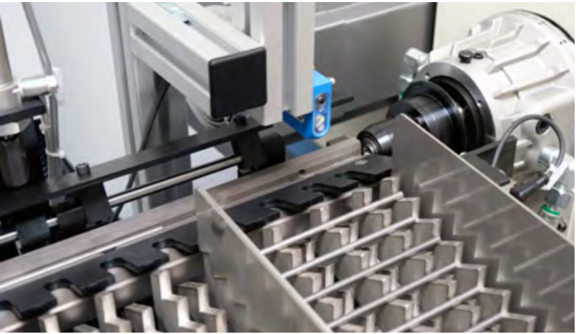
1 Zuführung des Rohteils über LP-Stufenförderer
