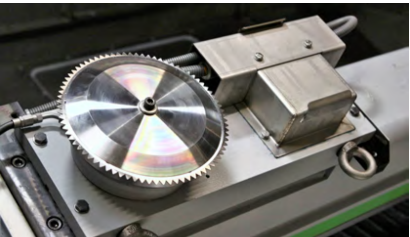
3 Aufspannung zur Verzahnung von Rundmessern mit bis zu 200 mm Ø
