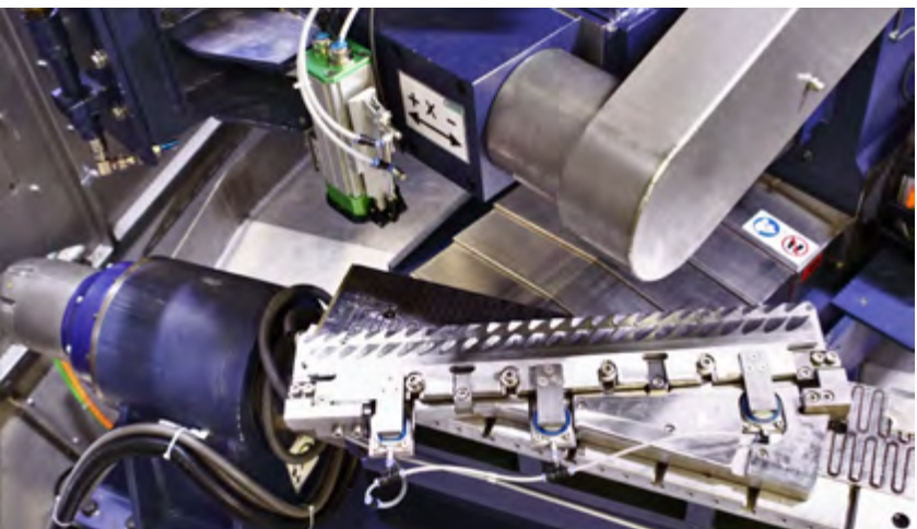
4 Verschwenken der Schleifstation zum Erzielen des Hinterschliffs; zusätzliche Spannvorrichtung bei größerem Hinterschliff
