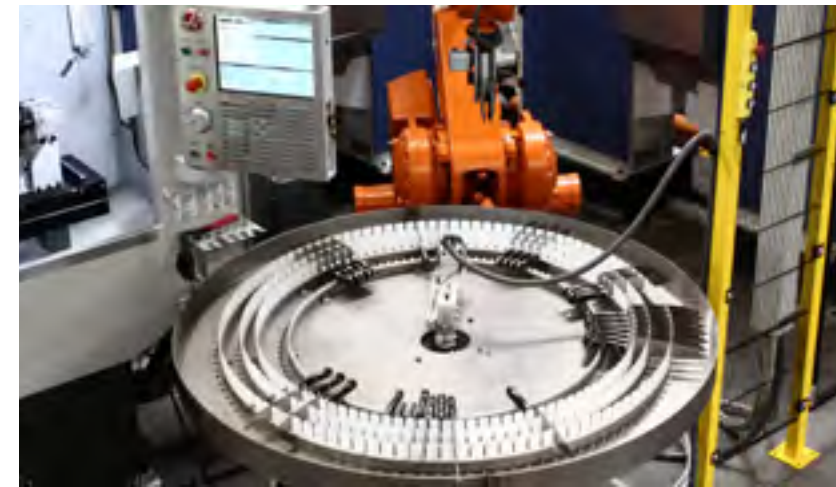
Indexierendes Rundtisch-Magazin für Messer
