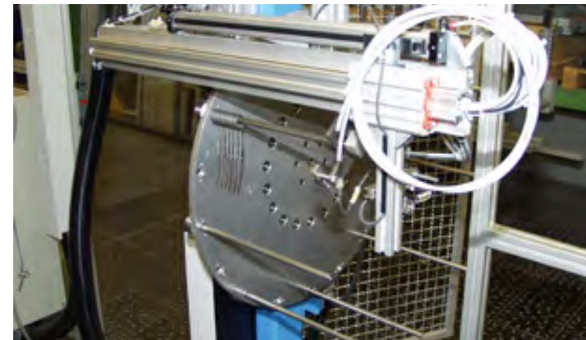
Indexierendes vertikales Rundtisch-Magazin für Scheren
