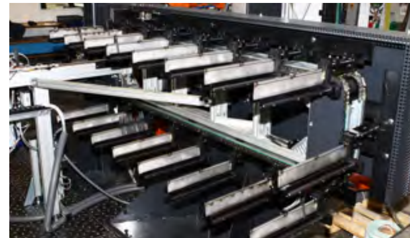
Umlaufendes Kettenmagazin für Zangen
